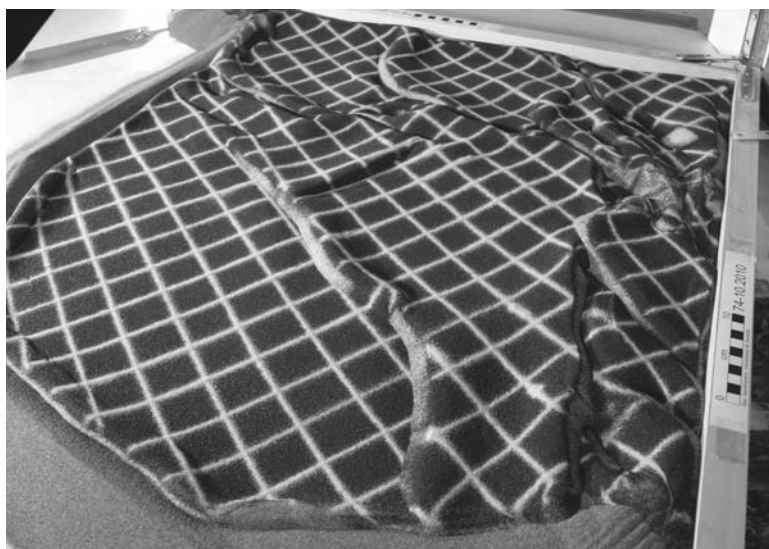
Fig. 3.- Fotografía del estadio final del experimento. Obsérvense las estructuras arqueadas en la parte trasera del modelo y los dos cabalgamientos subperpendiculares en su parte frontal.
